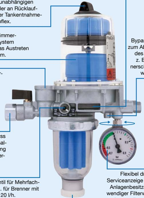
Flexibel drehbare Serviceanzeige für den Anlagenbesitzer. Notwendiger Filterwechsel kann selbst erkannt werden. Ist der Filtereinsetz verschmutzt, steigt das Vakuum an und der Fachhandwerker kann informiert werden.
