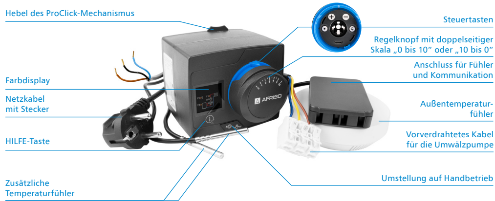
Abb. 1. Aufbau des Witterungsgeführter Regler ARC 345 ProClick.
